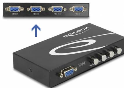
1. È possibile collegare fino a quattro computer con porta VGA ad un monitor, TV o proiettore ecc. con porta di ingresso VGA. Tramite il pulsante è possibile selezionare su quale dispositivo visualizzare il segnale.
